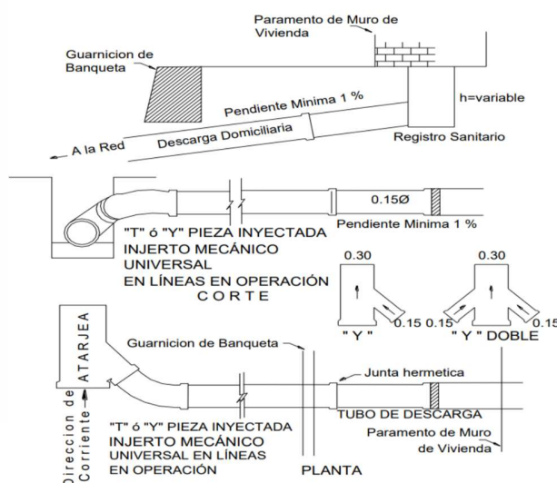
Registro tipo de drenaje sanitario
